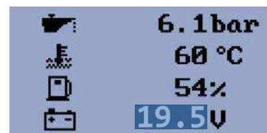
рисунок 15 - отображение тревожного сигнала на экране измерений
