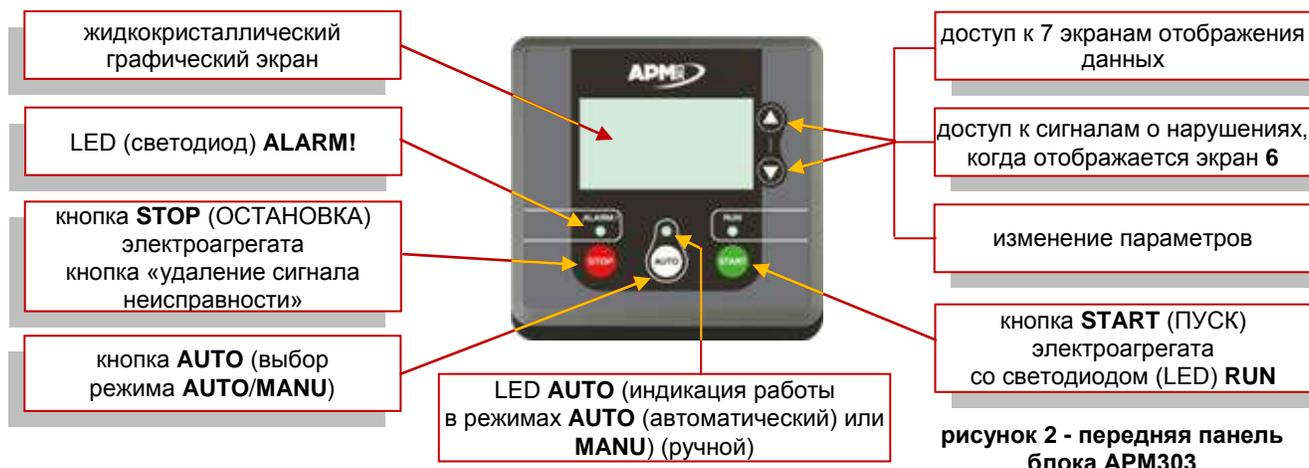
рисунок 2 - передняя панель блока APM303
