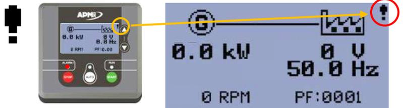
рисунок 14 - появление сигнала неисправности
