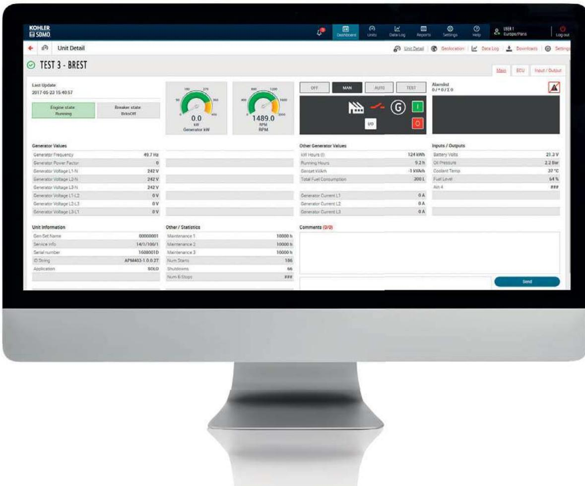
► Интерфейс не входит в стандартную конфигурацию. Это опция. Дает многочисленные возможности от контроля электроагрегата и до полного управления и технического обслуживания. Параметры работы электроагрегатов регулируются через сервер по сетям связи GSM/3G/4G. Доступ к интерфейсу обеспечивается через ПК, планшет или смартфон.
